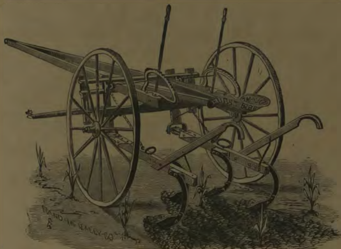
Garden City combinirter Cultivator mit verbesserter Kuppelung.
